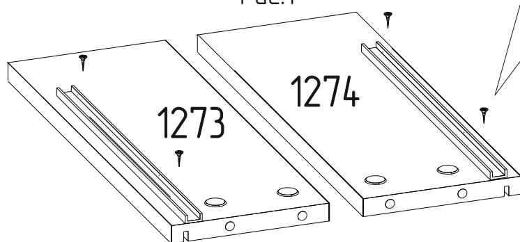
2. Прикрепить направляющую к боковым стенкам ящика с помощью шурупов 3,5x13 через отверстия (2) рисунок 2.
