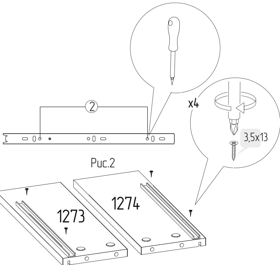
9 Установка боковых стенок ящика
