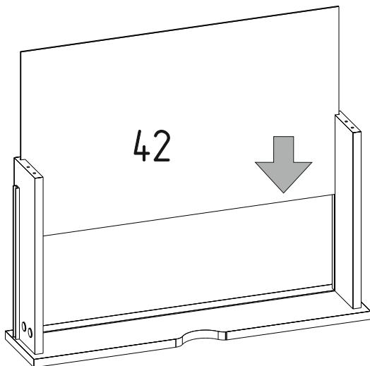
**11** Установка задней стенки ящика
